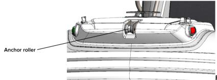
Fig. 39. Anchor roller.
